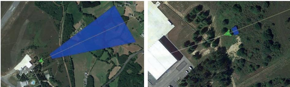
**Figura 19.6.** Campo de visión con exactitud según el ángulo *tilt* del UAS y altura de vuelo (dcha.) y alto error del campo de visión por baja altitud y ángulo de *tilt* excesivo y cercano al horizonte (izq.). La línea amarilla es la dirección de apuntamiento (imágenes cedidas por la empresa AVINCIS).
