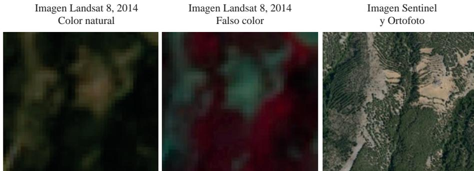
**Figura 5.4.** Imágenes Landsat 8 (color natural y falso color) y mosaico de ortofoto PNOA e imágenes Sentinel 2 A de un área forestal de la Sierra de los Filabres (Almería) (EPSG 3857, Nivel de zoom 16, Escala 1:8530).
