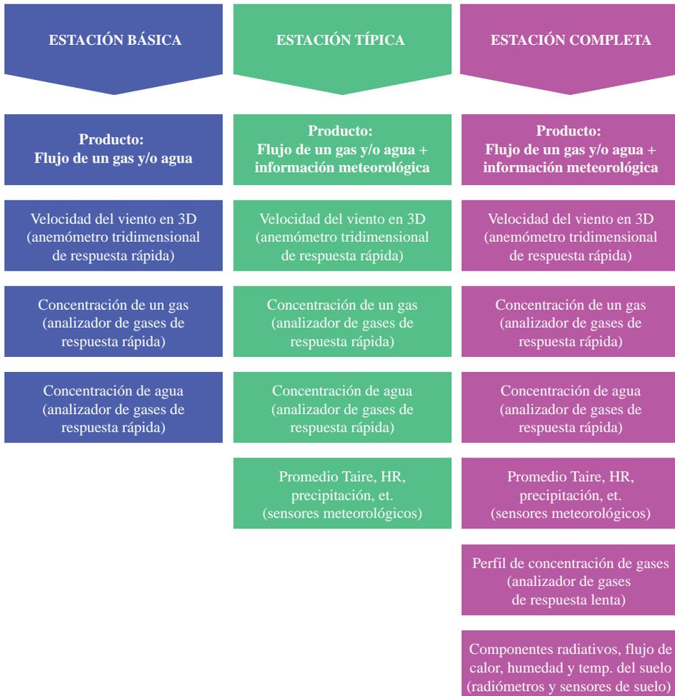
**Figura 2.4.** Diseño experimental de una estación de EC.
